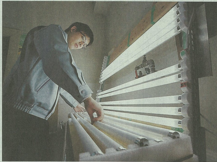
豊光社の省エネ蛍光灯。出荷前に明るさを消費電力がチェックされる。4日、北九州市小倉北区上町津、溝脇正撮影
